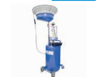
Zlewarko-wysysarka do oleju 90 litrów ze zbiornikiem kontrolnym
