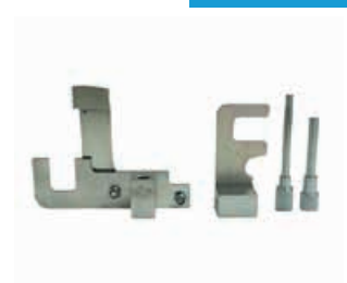
Blokada rozrządu 1,5 / 1,9 / 2,2 / 2,5 dCi Renault Opel Nissan Suzuki
